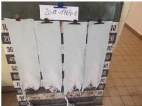
2.2.1 Normalentflammbarkeitsprüfung nach DIN 4102-1
